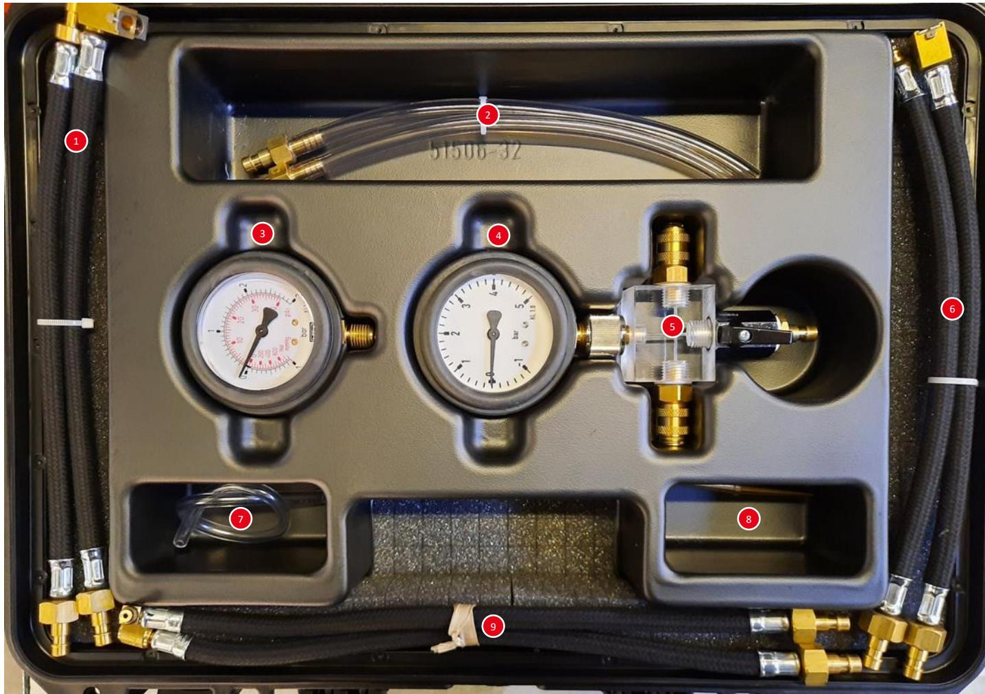
Anschlussleitungen B 1x für Injektor und 1x für Rücklauf (BOSCH)
