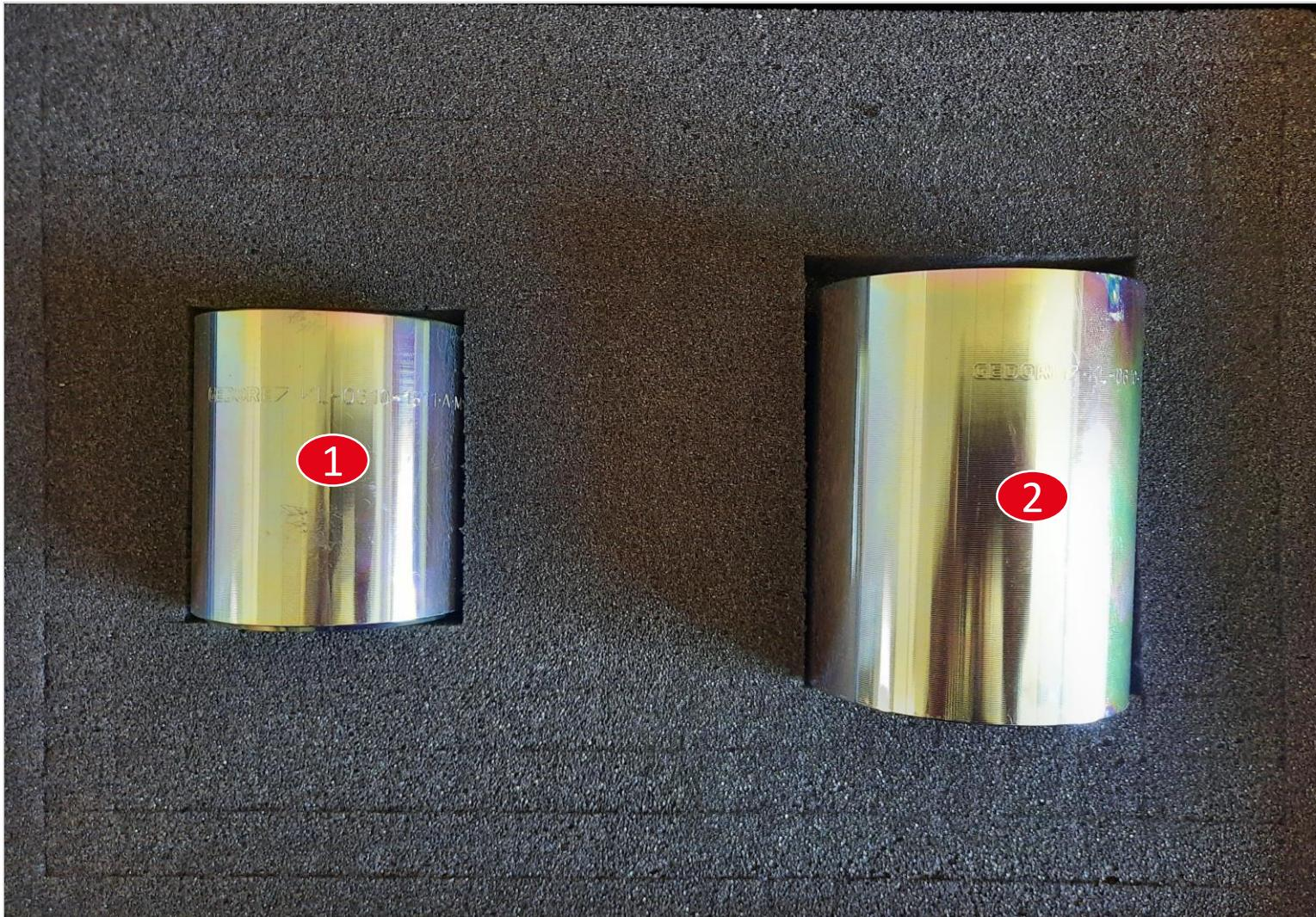
1 Druck-/Stützhülse ø 59,3/52 mm
